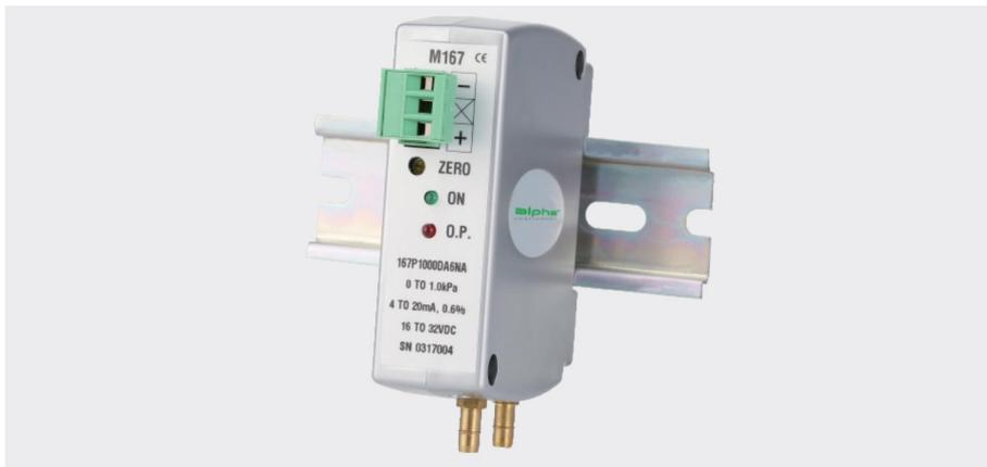
Model 167 系列微差压传感器的核心部件是一个电容式压力敏感元件，由不锈钢膜片与固定电极构成一个电容，其值随压力变化而变。采用本公司特殊专利技术精心设计的传感器敏感元件和独特的检测电路确保了产品良好的温度性能和长期稳定性。
